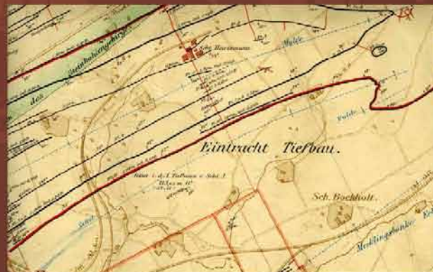
Teil eines Grubenplans der Zeche Eintracht Tiefbau von 1881, der die oberirdisch Gebäude und die Flözverläufe unter Tage zeigt. Oberhalb der Bildmitte ist Schacht Heintzmann zu erkennen.
